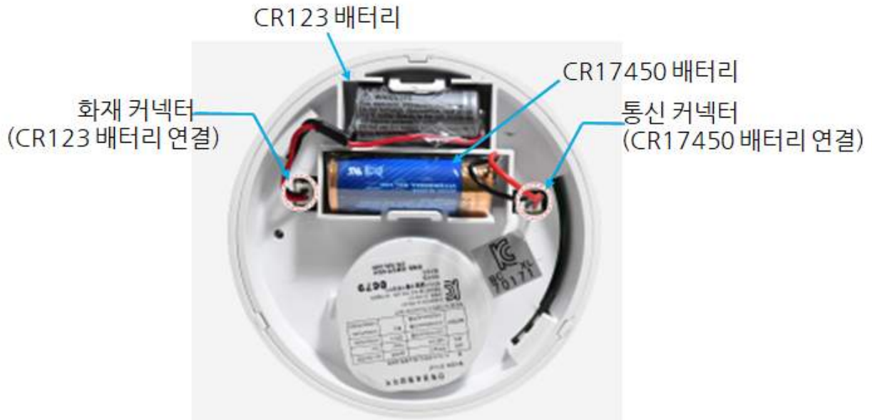
[화재 감지기 내부 배터리 위치]
